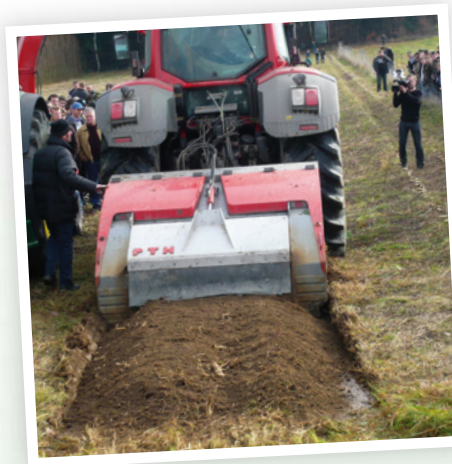
Rekultivierung der Pflanzenreihen mit Forstfräse
